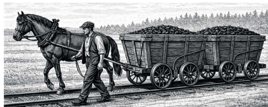
Zpočátku provozu na koněspřežné dráze se vlaky pohybovaly rychlostí chůze. Přibližně od strážního domku Schwarzes Rössl (u usedlosti Černý koníček v úseku Jenče – Pavlov) pak ložené vozy jely do Prahy samsopádem a bylo je nutno brzdit. Jak to mohlo před téměř 200 lety vypadat v krajině zobrazené na horním snímku, ukazuje ilustrace vytvořená s pomocí AI.
