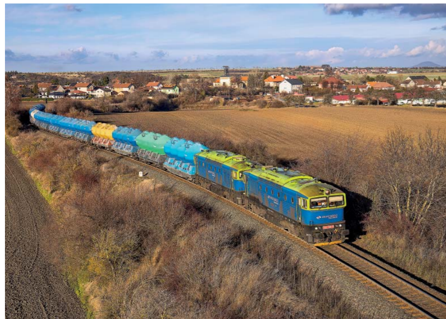
Další komoditou přepravovanou na trati Kralupy nad Vltavou – Kladno, je starý známý odsířovací vápenc. Na rozdíl od vápence pro severočeské elektrárny, který se dopravuje v kamenné podobě, jsou dodávky pro Elektrárnu Kladno ve formě vápenné emulze dopravované v nádržkových vozech, tzv. Rajkách. Na záběru z prosince 2025 vlak odjíždí ze stanice Brandýsek do cílové stanice Kladno-Dubí. Uprostřed horizontu vystupuje těžní věž bývalého dolu Michael v Brandýsku a zcela vpravo pak bájná hora Říp
